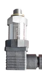
美国NVK压力传感器是基于放置在不锈钢膜片上的薄膜敏感元件技术,采用最新瑞士Metallux 芯片和紧凑不锈钢构造,使传感器非常坚固和可靠,适用于高压冲击、震动、高低温的恶劣液体条件中,如注塑机、压铸机、油压机等。
